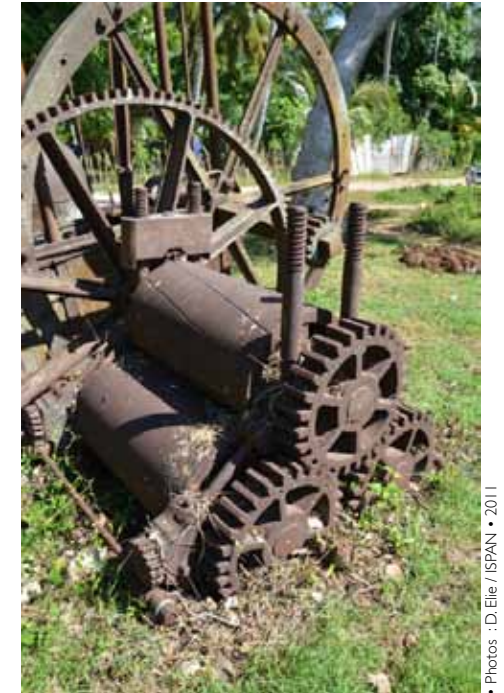
• Les roles, les engrenages et les barres de réglage
