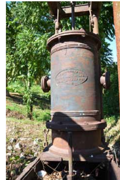
• Le cylindre à piston et ses deux entrées latérales
